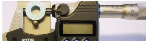
Les anneaux de température peuvent être utilisés aussi bien dans un four conventionnel que dans un four à passage, et sous différentes atmosphères(\*). Sept modèles d'anneaux de température couvrent une plage allant de 560°C à 1750°C.
